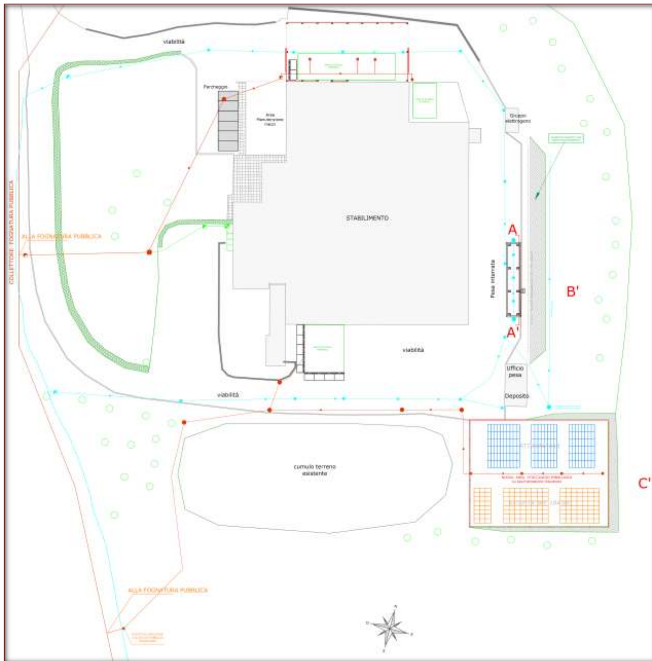
Figura 38: PLANIMETRIA RETE ACQUE – IMPIANTO DI SELEZIONE
